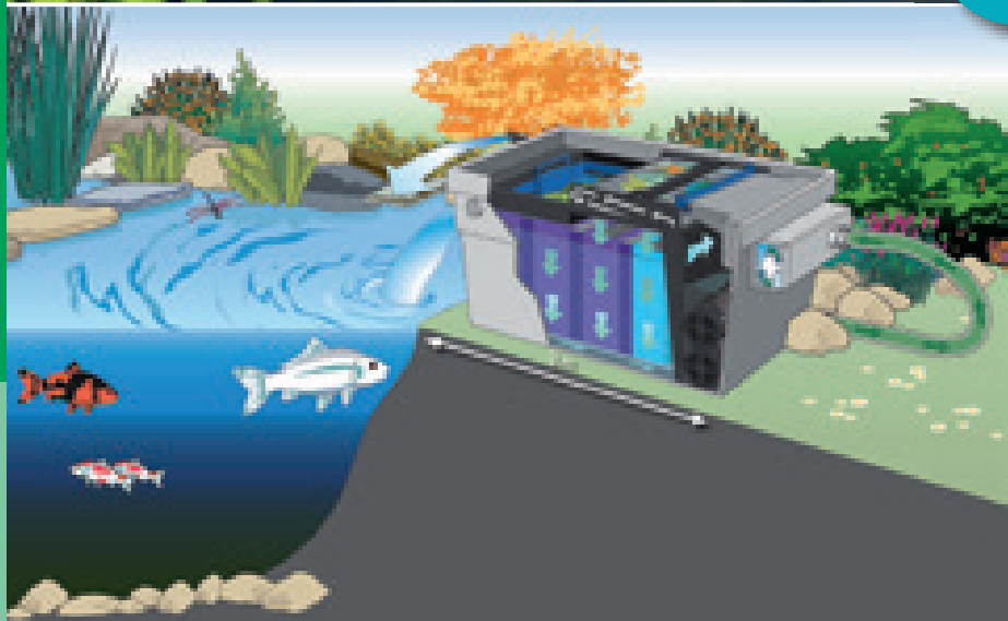
Représentation schématique : Filtre à ultraviolets combiné à un filtre gravitaire OASE BioTec ScreenMatic²
